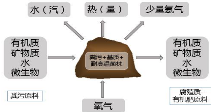
图 4.2-3 微生物好氧发酵机理示意图
