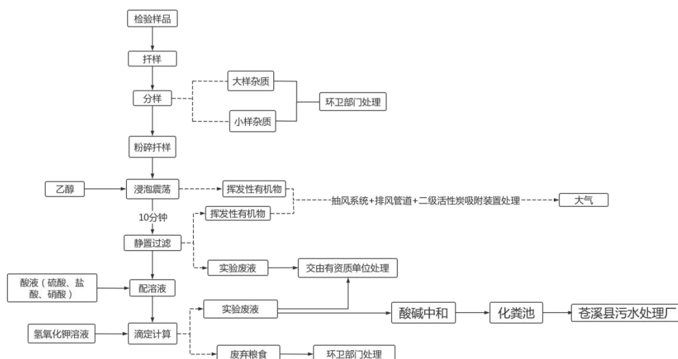
图 2-13 脂肪酸值检验工艺流程及产污位置图
