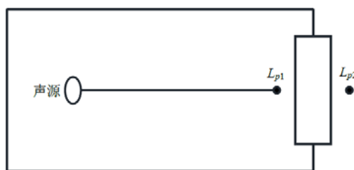
图 4-2 室内声源等效为室外声源图例
